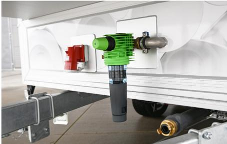
Frischwasseranschluss mit Druckminderer und Wasserfilter, Abwasseranschluss, 400 V-Eingangsstecker
