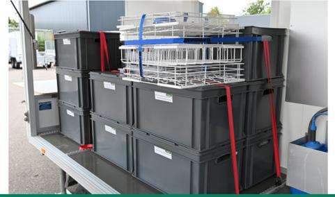
Ladungssicherungssystem inkl. Spanngurte für sicheres Verzurren der Ladung
