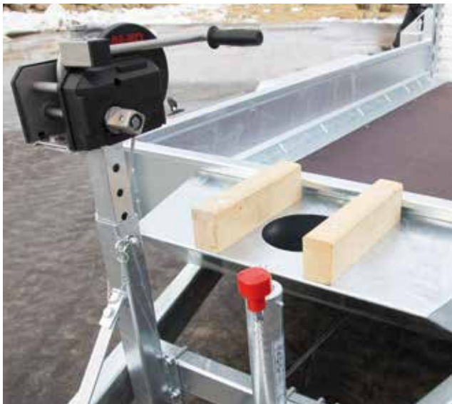
Baggerarmauflage & Seilwindenbock inkl. Handseilwinde
