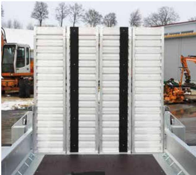
Gummiauflage mit Stahlkern auf Auffahrschienen
